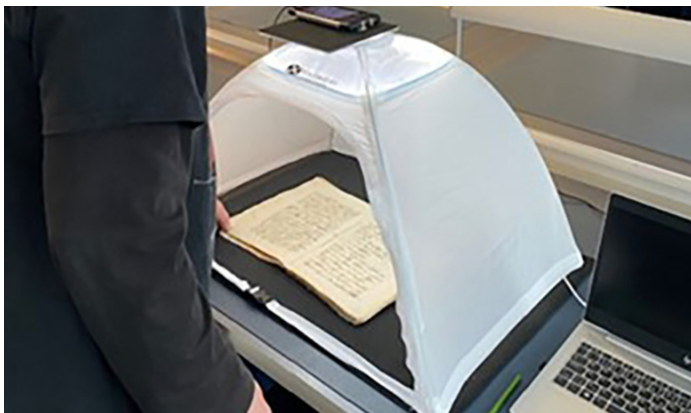
Obr. 9 Zařízení ScanTent, snímání rukopisu (archiv autora)
