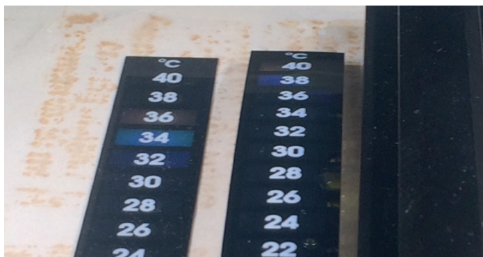
Obr. 4 Měření teploty po 20 minutách v rozptýleném viditelném světle. Teploměr vlevo je umístěn pod skleněnou tabulku, teploměr vpravo je na povrchu skla.
