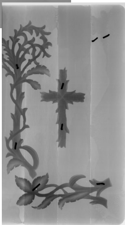
Obr. 3 Samostatná dřevěná deska knihy částečně pokrytá plechem. V oblasti, kde se nevyskytuje kovová vrstva, jsou zobrazeny (pouhým okem neviditelné) letokruhy samotného dřeva. Knižní deska umístěná přímo na detektoru pokrytém folií, rentgenka ve vzdálenosti 49 cm od detektoru, napětí na rentgence 70 kV, proud 300 \mu A, ozařovací doba pro pořízení snímku 1s. Grafická úprava: ořez; retuš pomocí nástroje záplata a bodový retušovací štětec; korekce gama 1,50; expozice +2,00; kontrast 100 (aplikace na vnitřní strukturu). Nebeklíč, 19. stol.
