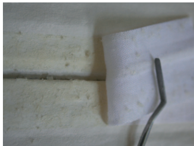
Obr. 34 Odstraňování textilní pásky toluenem (fond NK ČR)
