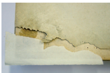
Obr. 23 Doplnění ztráty ručním papírem (archiv autora)
