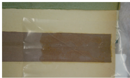
Obr. 32 Odstraňování klišové pásky 5% Tylosou MH6000 (fond NK ČR)
